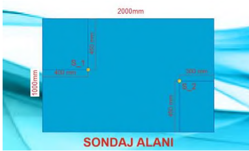
Şekil-35-b Görev 4 malzemesinin yerleştirileceği su havuzu ölçüleri (Üst Görünüm)
